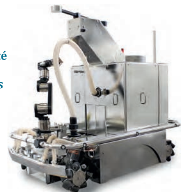
Robot téléopéré Gobie permettant d'assainir les zones de travail. ©CEA
