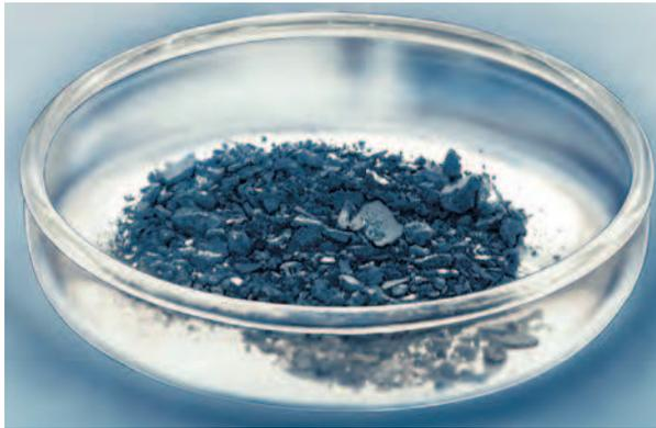
Fig. 37. Dépôts de Mo-Zr prélevés sur un dissolvant de l'usine UP3 de La Hague.
