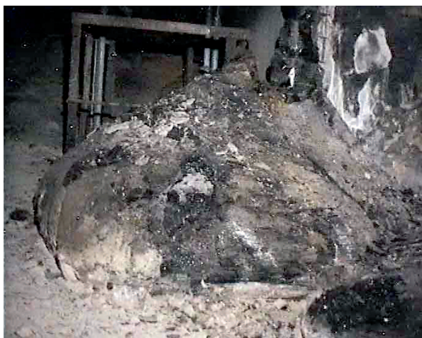
Fig. 204. Le corium de Tchernobyl en fond du bloc réacteur.
