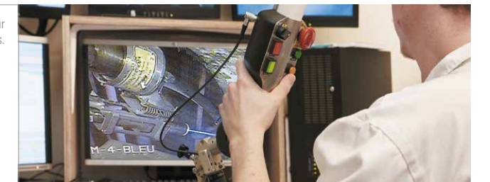
Utilisation du bras téléopéré Maestro pour le démantèlement d'installations nucléaires.
