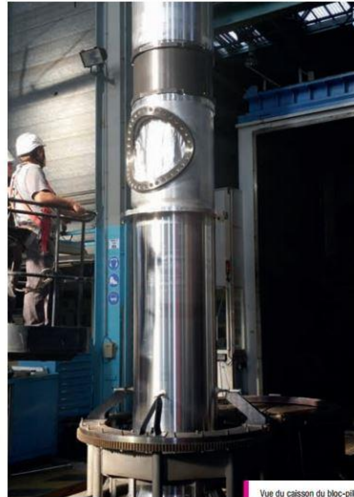
Vue du caisson du bloc-pile.
