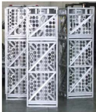
Emballages de transport (0,6mx0,6mx1,821m) (Crédit Photo CEA Cadarache)
