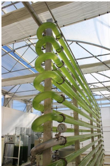
Photobioréacteur tubulaire à la Cité des énergies
