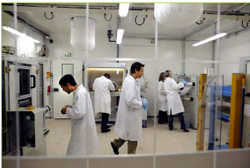
La salle anhydre est une salle à l'atmosphère contrôlée pour la conception des nouvelles batteries. Elle est la première tranche du déploiement de la plate-forme STEEVE.
