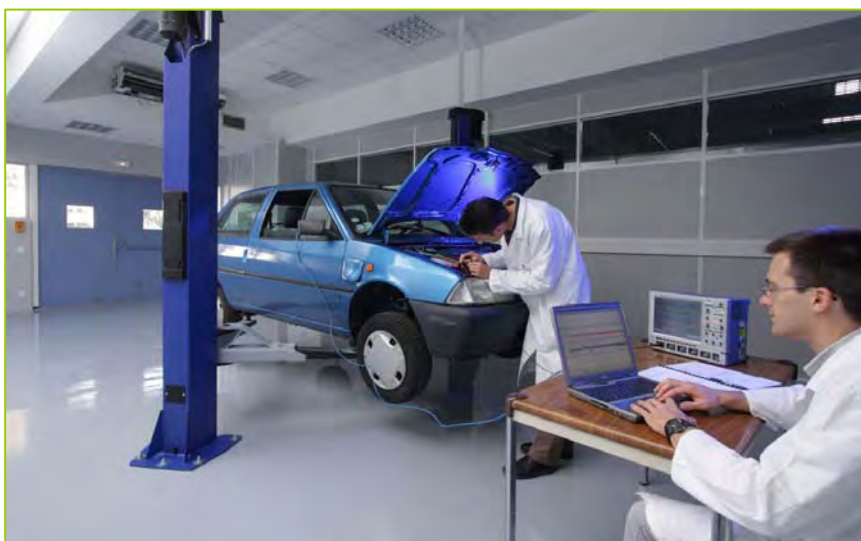
Séance de monitoring sur une pile automobile Li-ion. L'optimisation de l'autonomie de la voiture électrique passe aussi par l'amélioration de la gestion du stockage de l'électricité et son utilisation.
