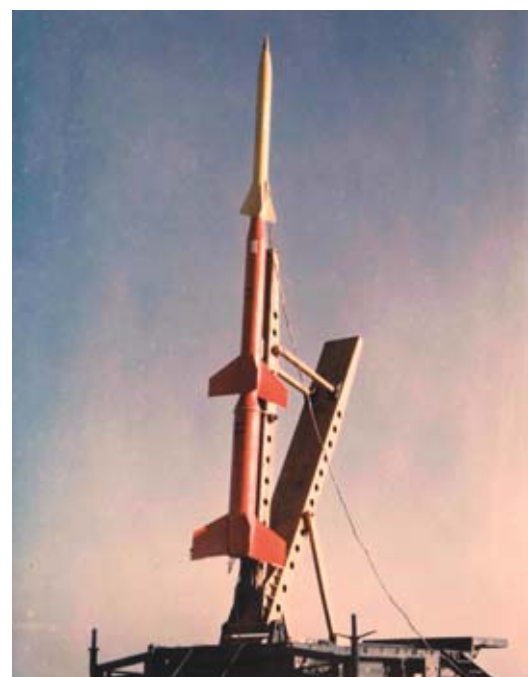
La première expérience spatiale du CEA, le 27 janvier 1959. Un compteur Geiger a été installé à bord d'un missile pour une des premières mesures des rayons gamma du ciel.
