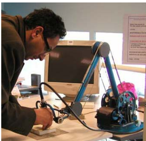
Expériences effectuées sur un matériau reproduisant la consistance de la mâchoire
