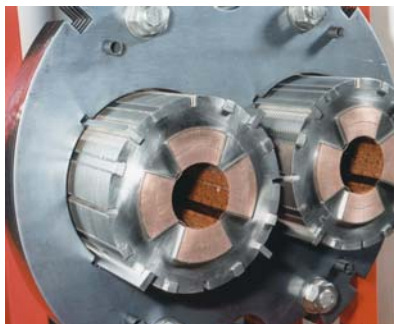
Conception des quelques 400 aimants quadripolaires qui équiperont le Large Hadron Collider (LHC) au CERN ; (CEA/Dapnia)
