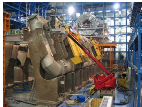
Aimant du détecteur Atlas, l'un des deux plus grands aimants supraconducteur du CERN
