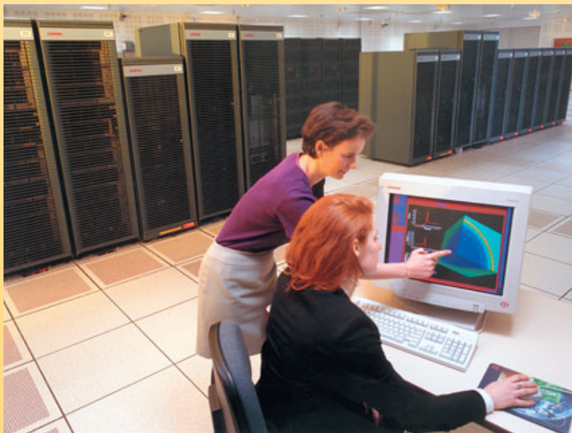
Installée en décembre 2001 au CEA (centre DAM-Ile de France) et conçue par Compaq (devenue depuis HP), la machine Tera a pour élément de base un mini-ordinateur à 4 processeurs Alpha à 1 GHz partageant une mémoire de 4 Go et fournissant une puissance totale de 8 Gflops. Ces éléments de base sont interconnectés par un réseau rapide conçu par la société Quadrics. Une opération de synchronisation sur l'ensemble des 2 560 processeurs s'effectue en moins de 25 microsecondes. Le système de fichiers global offre un espace de stockage de 50 téraoctets pour les entrées-sorties avec une bande passante agrégée de 7,5 Go/s.
