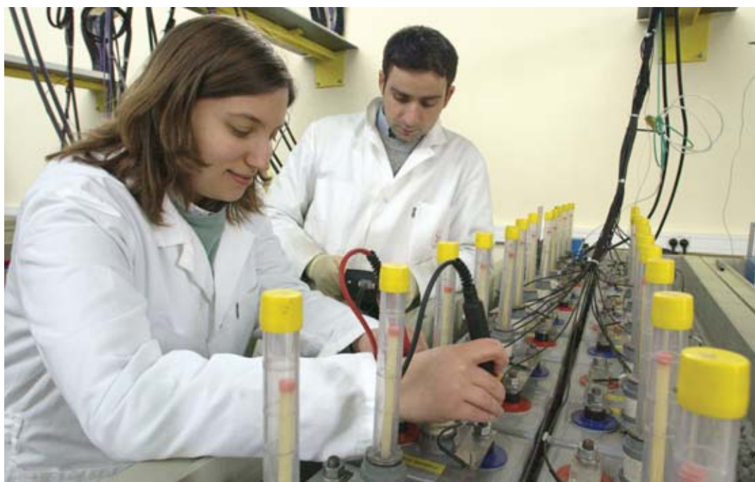
Des salariés du Genec, au CEA/Cadarache, font subir à des batteries des cycles de charge et de décharge, simulant ainsi des utilisations variées, vérifiant leur efficacité et étudiant le vieillissement de leurs composants.
