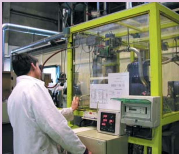
Machine à compression utilisant le propane comme réfrigérant. Elle est compacte, consomme peu d'électricité et présente une puissance thermique élevée.
