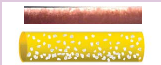
Figure b. Écoulement hétérogène ( V^{**} < V < V^{***} ).
