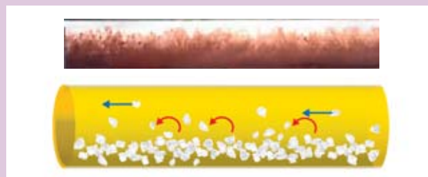
Figure c. Écoulement en lit mouvant ( V^* < V < V^{**} ).
