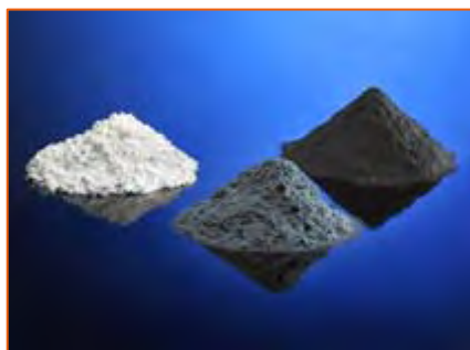
Poudre de matériaux actifs d'électrode pour accumulateurs Lithium-ion Crédit : Artechnique/CEA
