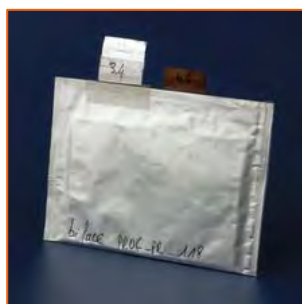
Accumulateurs 10Ah à base de Phosphate pour véhicule électrique (sécurité – 140Wh/kg) Crédit : PF.Grosjean/CEA
