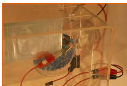
Test de cyclage d'accumulateur au lithium Crédit : CEA-TOTEM DE PIERRE
