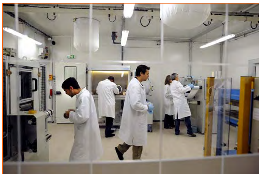
Les batteries Lithium-ion sont fabriquées dans une salle « anhydre ». L'air ambiant, strictement contrôlé, ne contient aucune humidité. Crédit : PF.Grosjean/CEA
