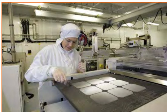
Chargement des wafers (tranches de silicium) dans l'équipement destiné au dépôt de cellules photovoltaïques à haut rendement basées sur le concept de l'hétérojonction sur le site de l'INES. Crédit : P.Dumas/CEA
