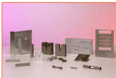
Panel d'échantillons usinés dans les cellules chaudes du LECI Crédit : F. Rhodes/CEA
