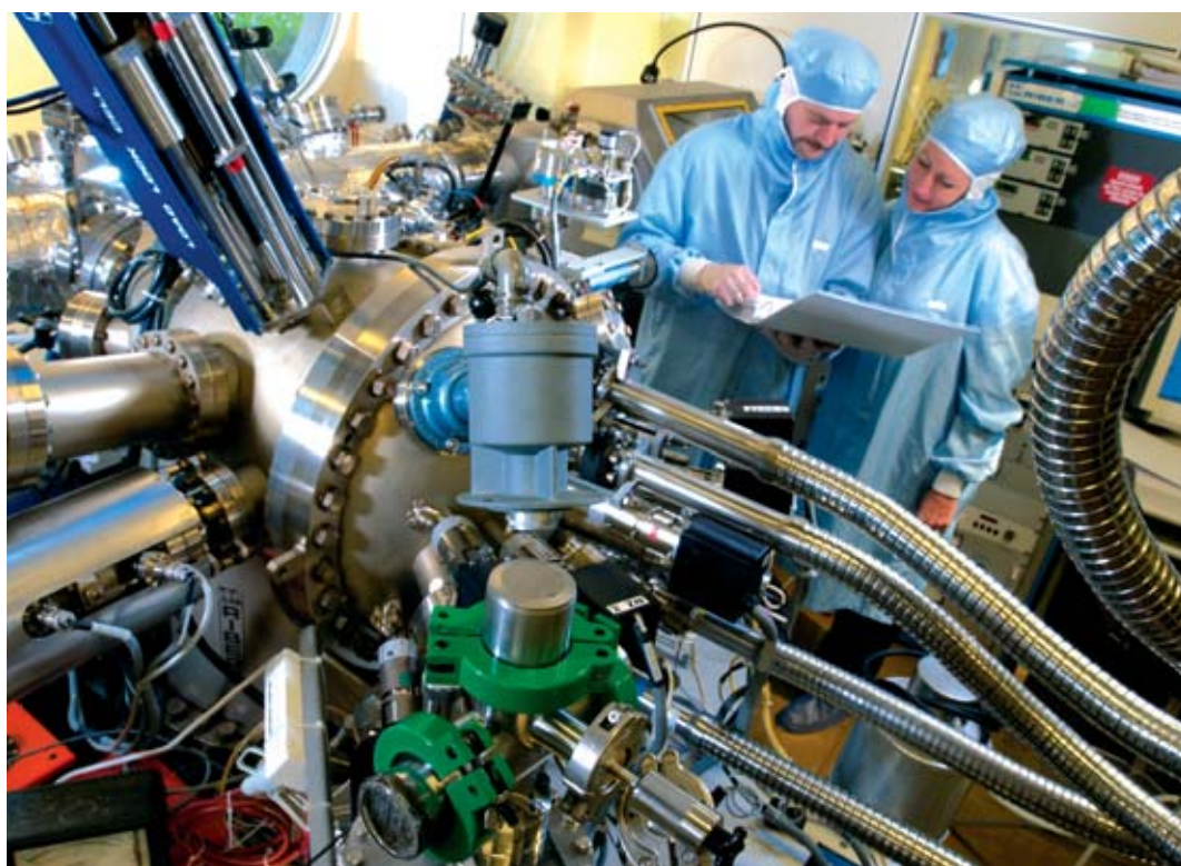
Machine d'épitaixie par jets moléculaires utilisée au centre CEA de Grenoble pour réaliser la couche active (en HgCdTe) utilisée dans les nouvelles générations de détecteurs infrarouge.
