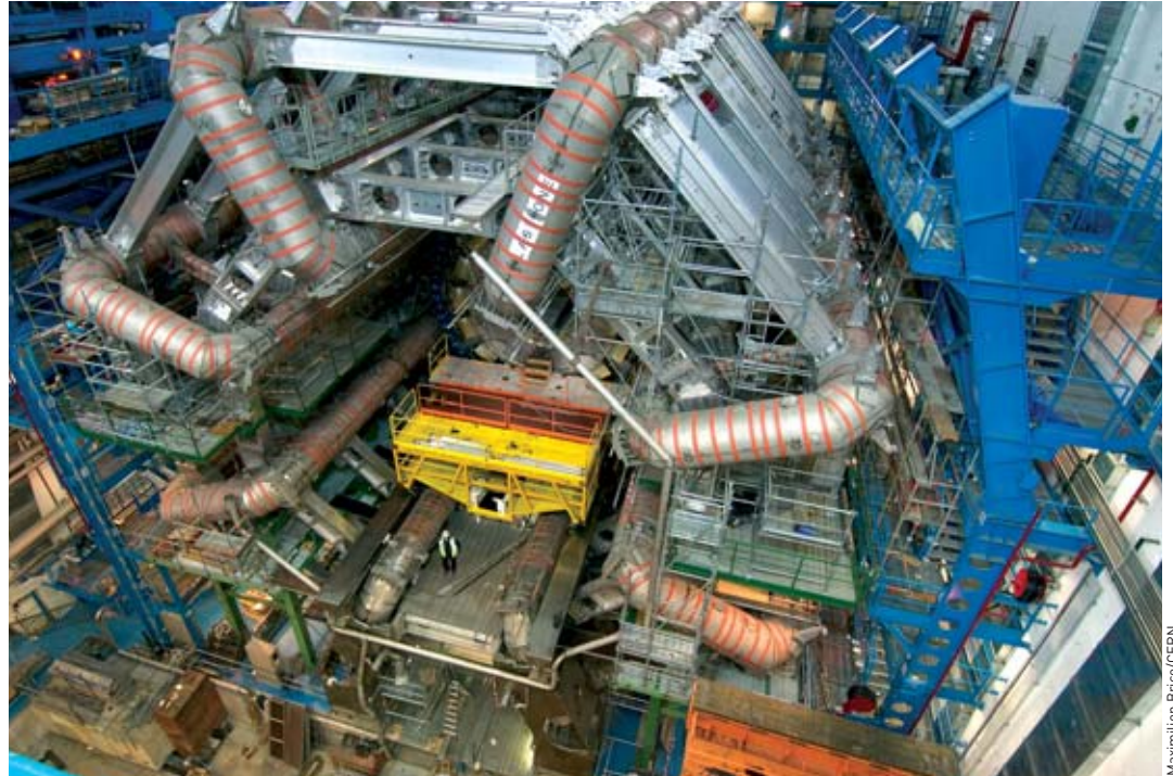
Vue générale du détecteur Atlas (A Toroidal LHC ApparatuS) avec ses huit aimants toroïdaux installés, en novembre 2005. Après avoir détecté ses premiers rayons cosmiques in situ dans son calorimètre hadronique, Atlas a commencé à faire fonctionner deux de ses trajectographes en juin 2006, pour enregistrer de tels rayons.
