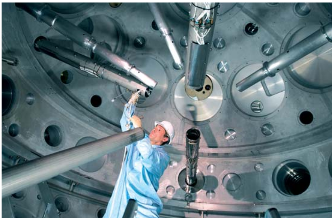
Contrôles de diagnostics à l'intérieur de la chambre d'expérience de la Ligne d'intégration laser (LIL), installation prototype du laser Mégajoule (LMJ) constituée d'une chaîne laser élémentaire comportant quatre faisceaux.
