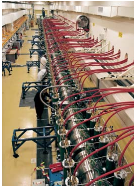
Hall de l'accélérateur Airix (Accélérateur à Induction de Radiographie pour l'Imagerie X) est constitué de 64 cellules à induction (auxquelles la haute tension est transmise par les câbles rouges) qui portent l'énergie des électrons à 20 MeV.
