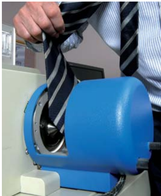
La source AccuTOF-Dart™ (Direct Analysis in Real Time) commercialisée par Jeol permet de détecter des explosifs sans préparation d'échantillon.
