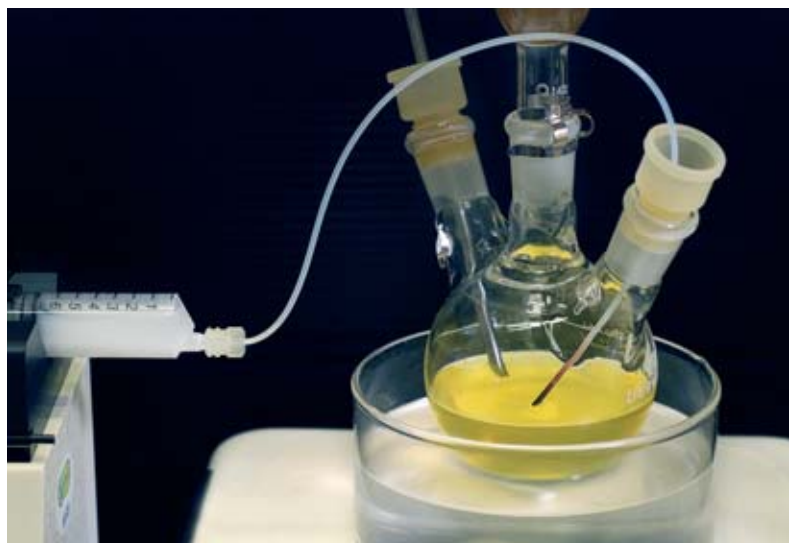
Synthèse de nanocristaux de semi-conducteurs. Ici, enrobage de nanocristaux de CdSe par une coquille de ZnSe/ZnS pour améliorer leurs propriétés optiques.
