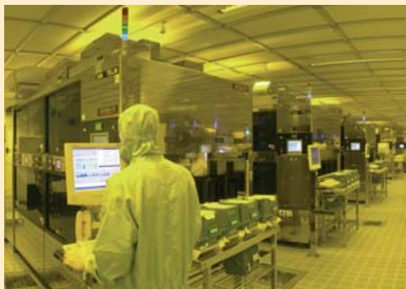
Zone de photolithographie en salle blanche dans l'usine STMicroelectronics de Crolles (Isère).
