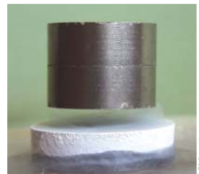
La découverte de la supraconductivité à haute température critique a rendu possible la vision directe à l'air libre d'une manifestation de la supraconductivité qui est celle de l'aimant flottant au-dessus d'une pastille d'YBaCuO refroidie à l'azote liquide et qui est maintenant bien connue.
