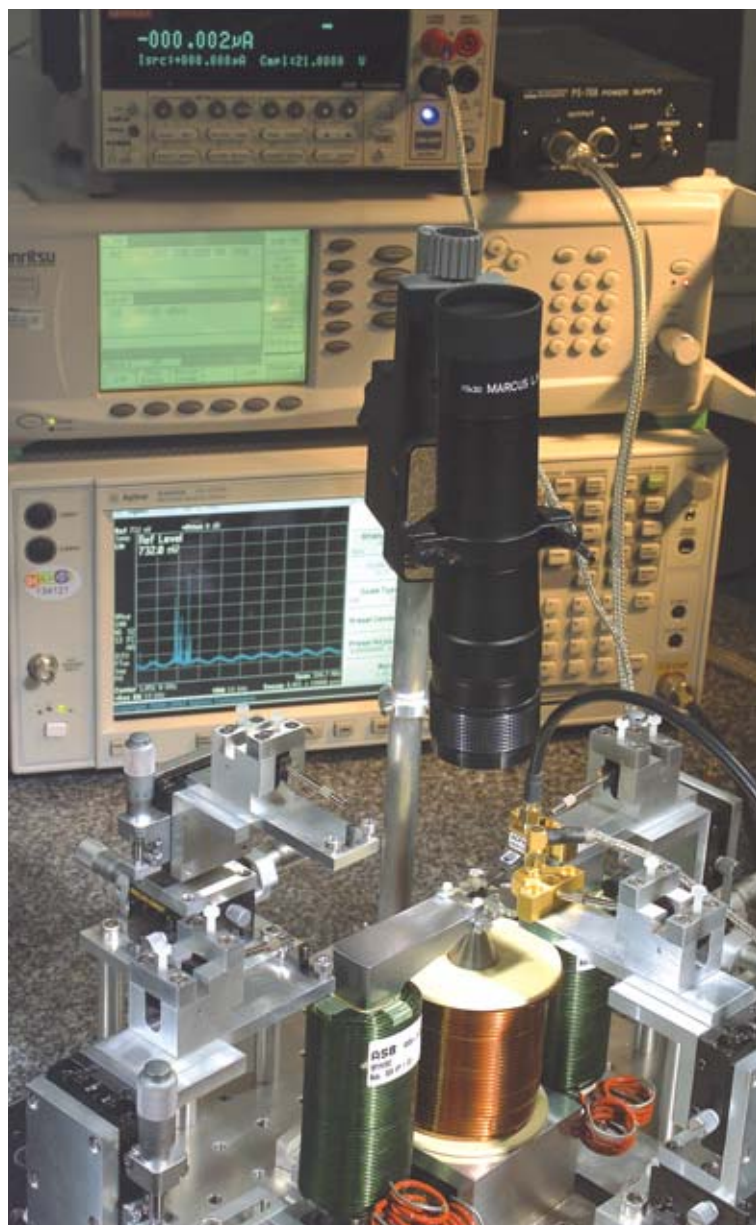
Banc de mesures électriques spectrales large bande (0-26 GHz) dédié à l'étude de nanostructures magnétiques à courant polarisé en spin au centre CEA de Grenoble.
