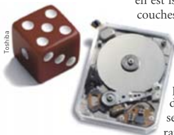
Figure 3. Disque Toshiba de 2 cm de diamètre avec une capacité de 4 Go pour un poids plume de 8,5 g!
