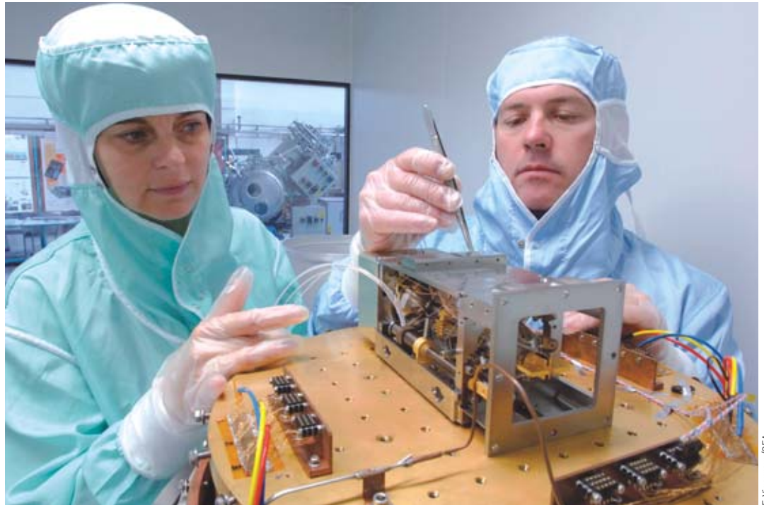
Essais thermiques sur le cryoréfrigérateur de recharge du satellite Herschel au service des basses températures du CEA à Grenoble.
