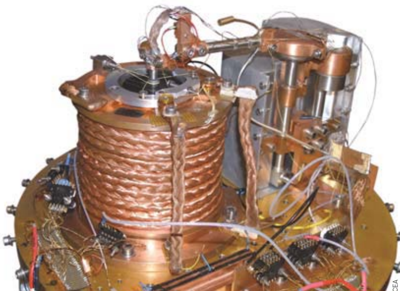
L'un des derniers prototypes de réfrigérateur développés par le laboratoire, capables de produire 48 mK.
