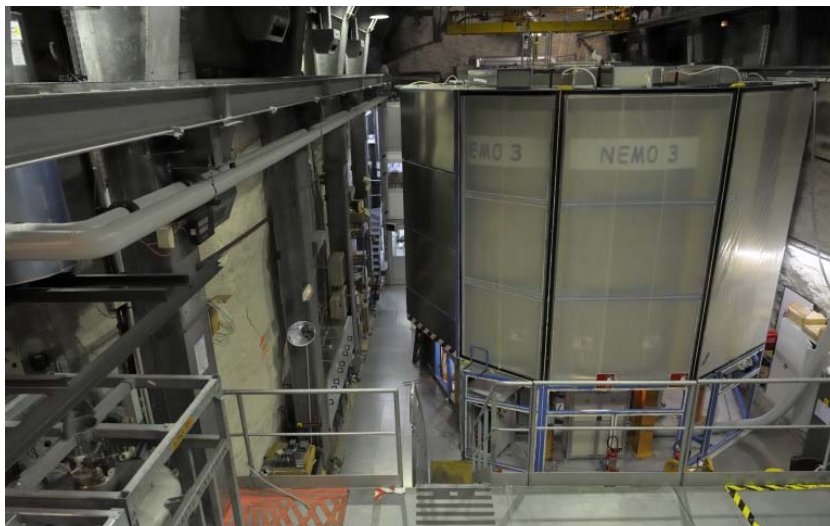
Détecteur NEMO 3 au cœur du LSM : une expérience de recherche de désintégration double bêta sans émission de neutrino.
