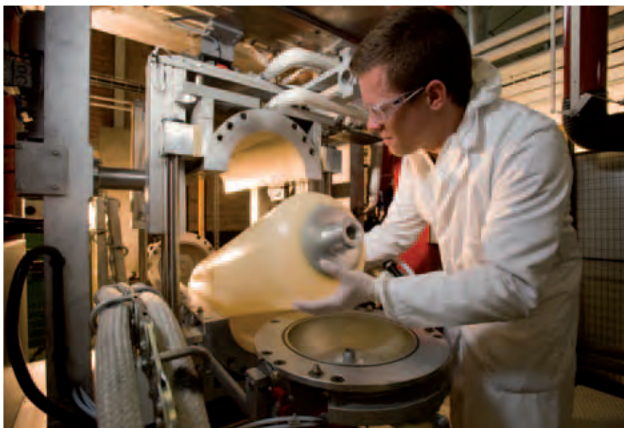
Test sur un réservoir d'hydrogène.
