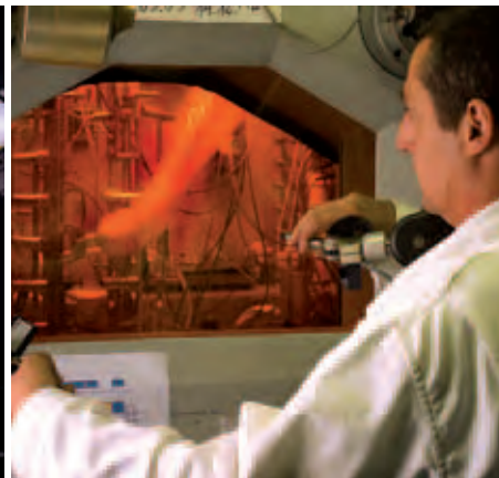
De g. à dr. : appareil de diffraction X pour la fabrication par voie sèche de combustibles – chaîne blindée permettant d'étudier le retraitement des combustibles irradiés.
