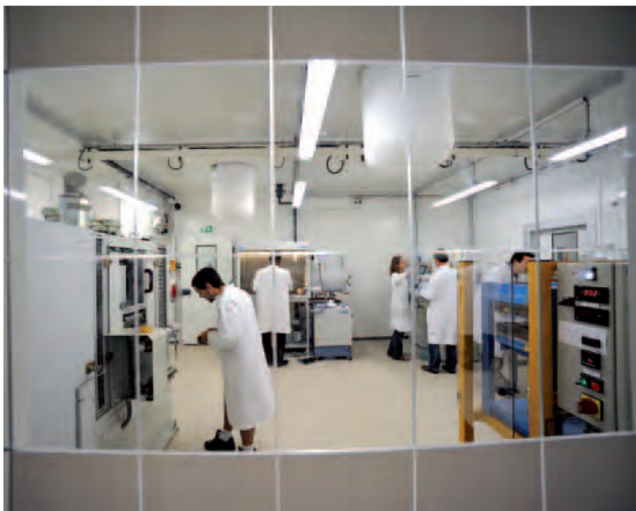
Mise en service d'une salle anhydre pour la fabrication de batteries lithium.
