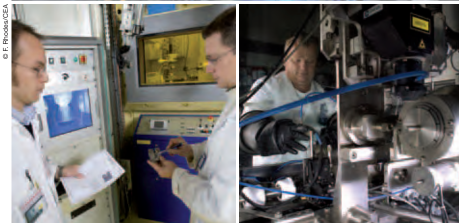
De g. à dr. : manutention en piscine du réacteur Osiris – préparation d'un programme de mesures dimensionnelles sur des combustibles irradiés – boîte à gants de soudage laser de gaines contenant les pastilles.
