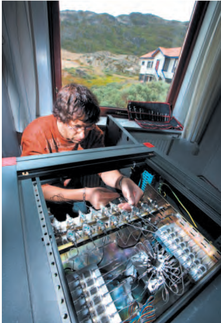
Connexion des dernières lignes (air et standard de calibration) sur l'instrument de mesure en continu du CO 2 .
