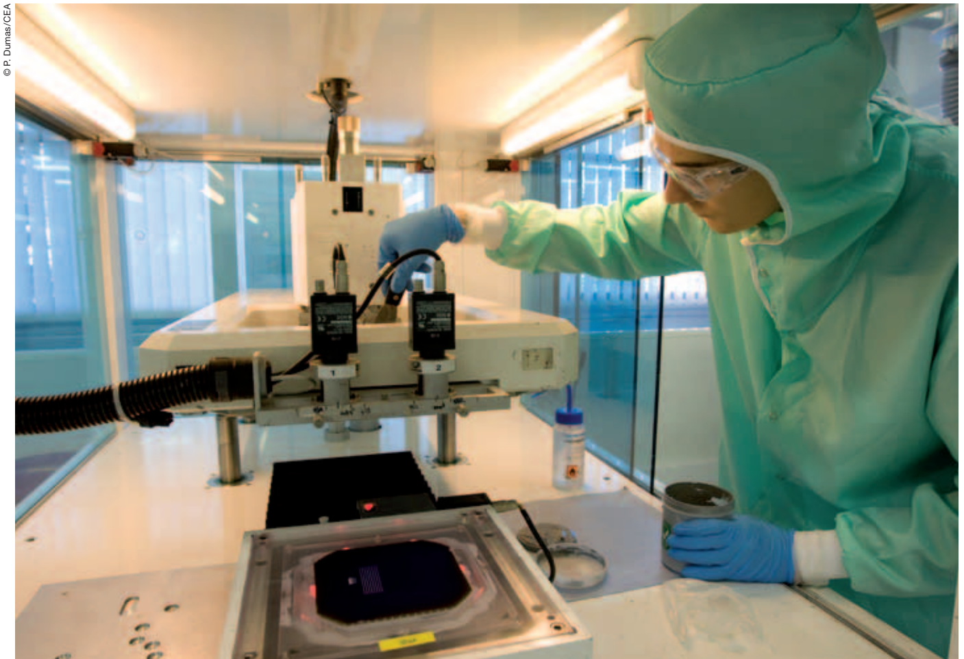
Sérisographie d'une cellule photovoltaïque sur la plate-forme Restaura.
