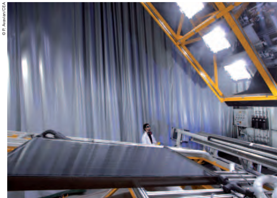
Banc d'ensoleillement pour tester la performance des capteurs solaires thermiques.
