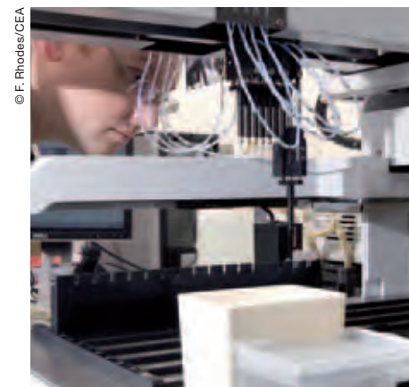
Mise en plaque robotisée d'échantillons ADN en vue du génotypage.
