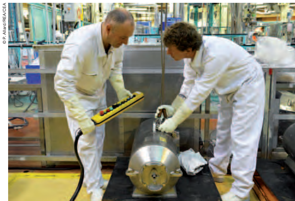
De g. à dr. : mise en condition d'un château de transport de radioélément artificiel à Osiris – dépôt de résine réalisé à la tournette sur un substrat verre.
