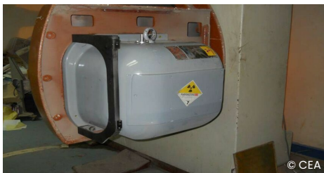
Tête du support métallique d'une source Co 60 et ses accessoires.
