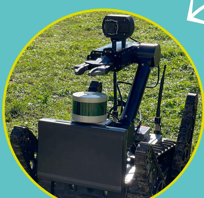
La faible masse et la forme compacte de Nanopix permettent de l'embarquer sur vecteurs robotiques légers afin de réaliser des mesures, à distance, dans les zones les plus difficiles d'accès ou fortement irradiantes.
