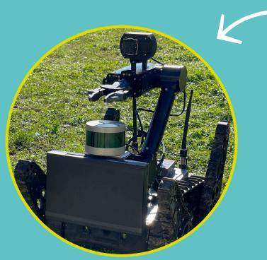
La faible masse et la forme compacte de Nanopix permettent de l'embarquer sur vecteurs robotiques légers afin de réaliser des mesures, à distance, dans les zones les plus difficiles d'accès ou fortement irradiantes.
