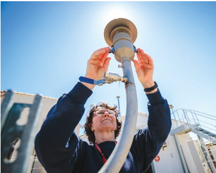
PRÈLEVEMENT D'UN FILTRE PAPIER PIÈGEANT LES AÉROSOLS DE L'AIR
