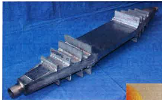
Récepteur solaire haute température (PEGASE / THEMIS)
