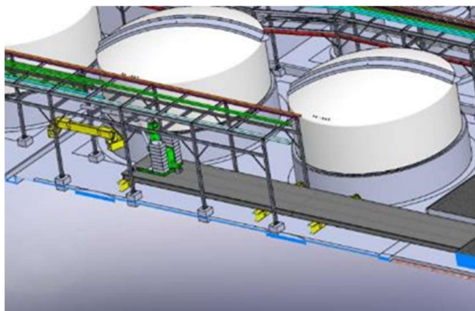
Figure 41 : Position du platelage le long de l'allée centrale de la « vallée des cuves »
