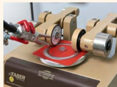
À droite, abrasimètre TABER® permettant d'étudier l'émission particulaire liée à l'érosion
