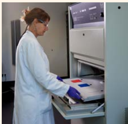
Au-dessus, vieillissement artificiel en chambre climatique.
