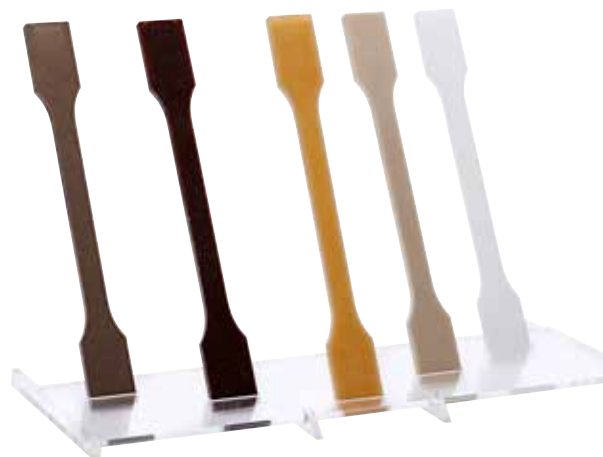
Éprouvettes de matériaux biosourcés. Fibres polymères en blanc, et fibres naturelles pour les éprouvettes colorées (lin, chanvre, coco).
