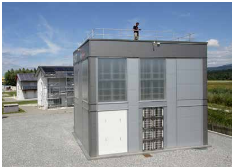
Maisons expérimentales du CEA pour le test de composants d'enveloppe.
