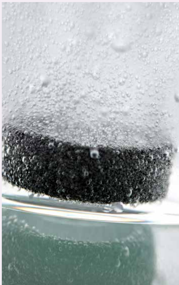
Catalyseur d'hydrolyse du NaBH 4 à base de Co supporté sur une mousse de nickel pour la génération d'H 2 .
