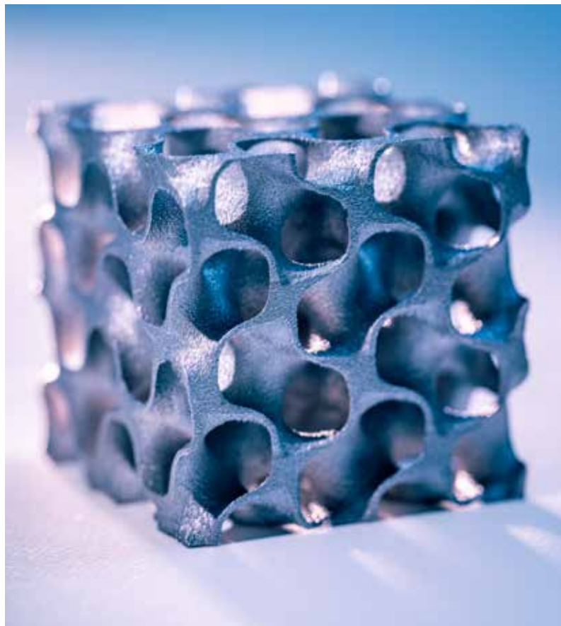
Exemple de structure cellulaire réalisée en impression 3D.
