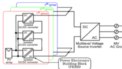
Figure 1: Système de conversion modulaire comportant un collecteur MVDC.
