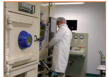
Mettre au point des radiotraceurs à injecter à l'homme nécessite des conditions d'hygiène très réglementées (salle blanche) et un équipement pour manipuler la radioactivité (cellules blindées). Ici les laboratoires de l'équipe de Louisa Barré au CI-NAPS à Caen.
