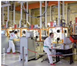
Chaîne pour les études de recherche et développement sur les procédés de fabrication des combustibles au plutonium (CEA Cadarache).
