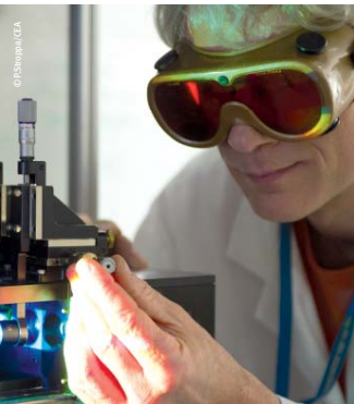
Réglage d'un trieur de cellules traité jusqu'à 50 000 cellules par seconde.
