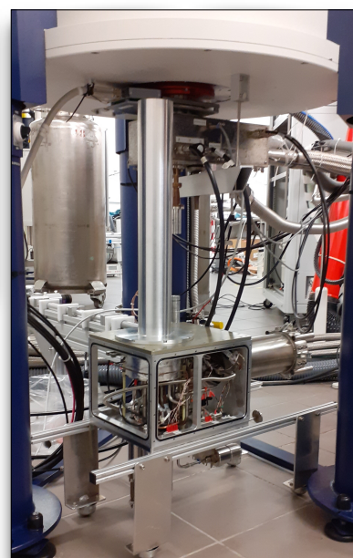
Figure 4 : La sonde PAVLOT sous l'aimant RMN
