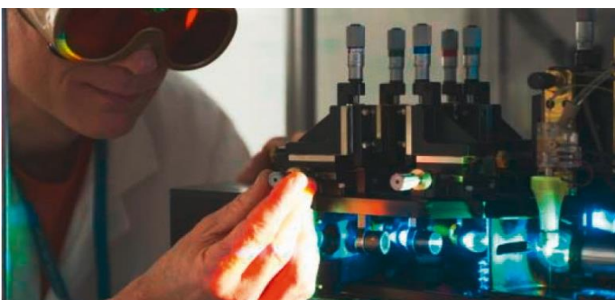
Réglage d'un trieur de cellules en flux, CEA-IRCM.
