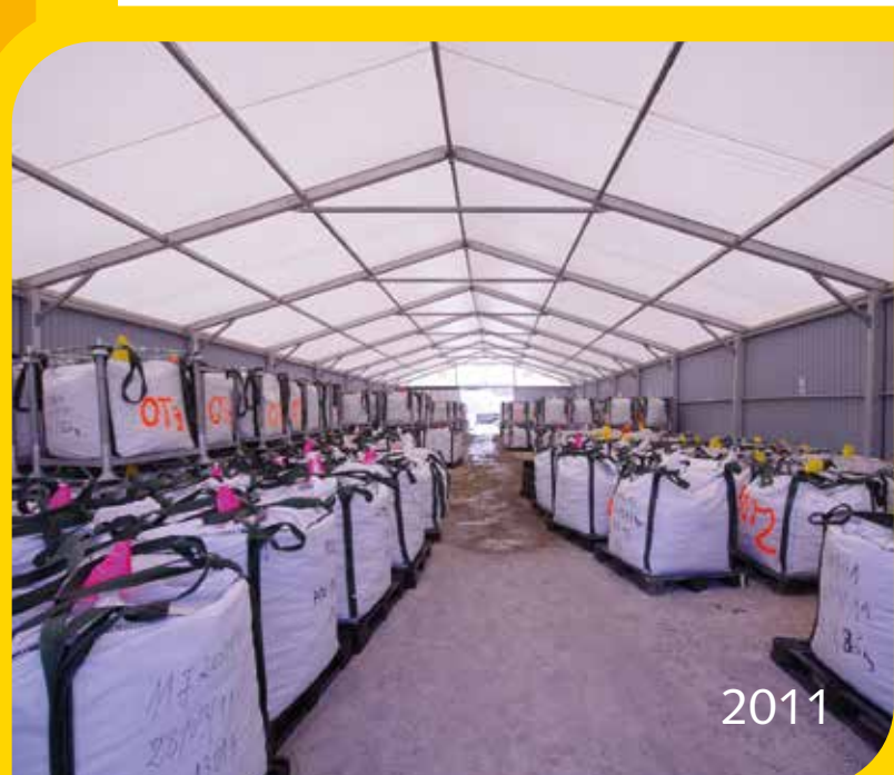
Entreposage des déchets en big bags à la STED avant envoi à l'Agence Nationale pour la gestion des Déchets RADIOactifs (ANDRA).
