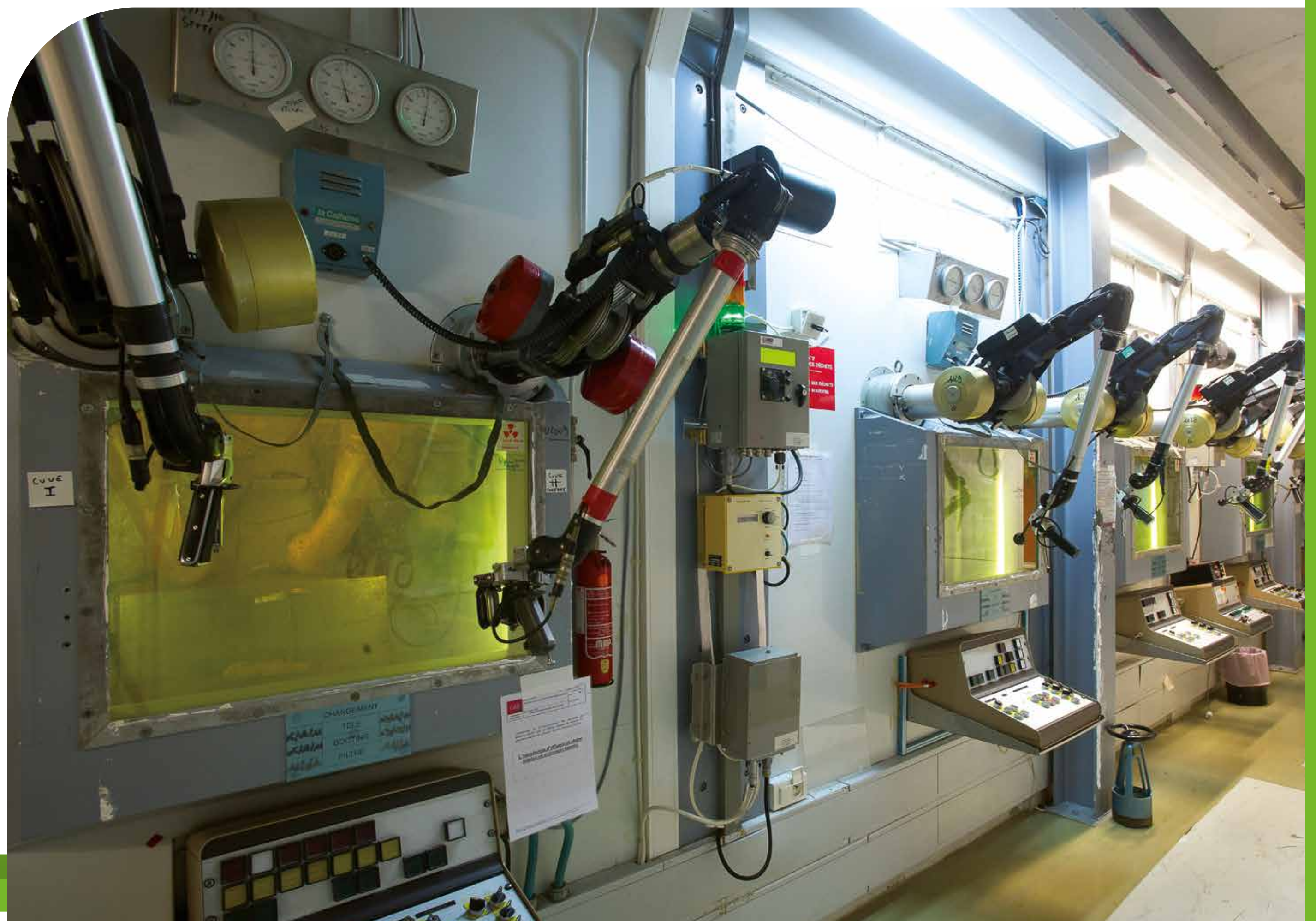
Une chaîne blindée est un dispositif de radioprotection qui permet de manipuler à distance des produits irradiants ou chimiques. Ici, la chaîne blindée Cyrano du bâtiment 18, vue de l'extérieur.
