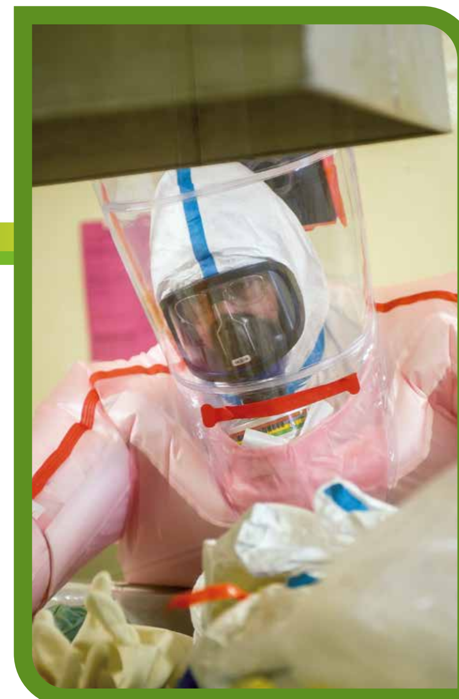
Tri des déchets FA (faible activité) en tenue isolante et ventilée.
