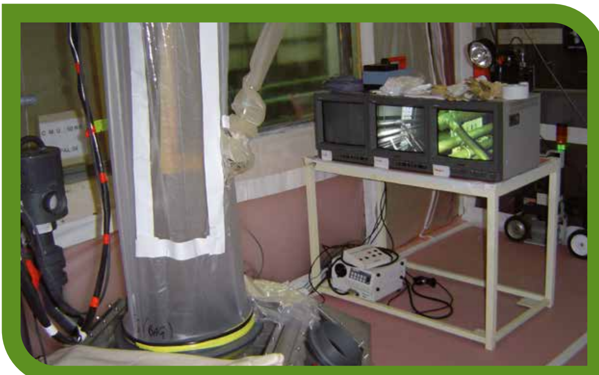
Dispositif d'inspection par caméra de la cuve B.
