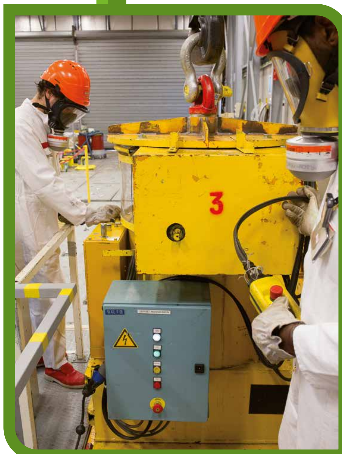
Conditionnement et évacuation de déchets irradiants au bâtiment 58. Déplacement d'un fût de 50l de déchets MI (moyennement irradiants) en château de transfert vers la cellule de mesure pour caractérisations radiologiques, avant surfûtage en fût de 60l.
