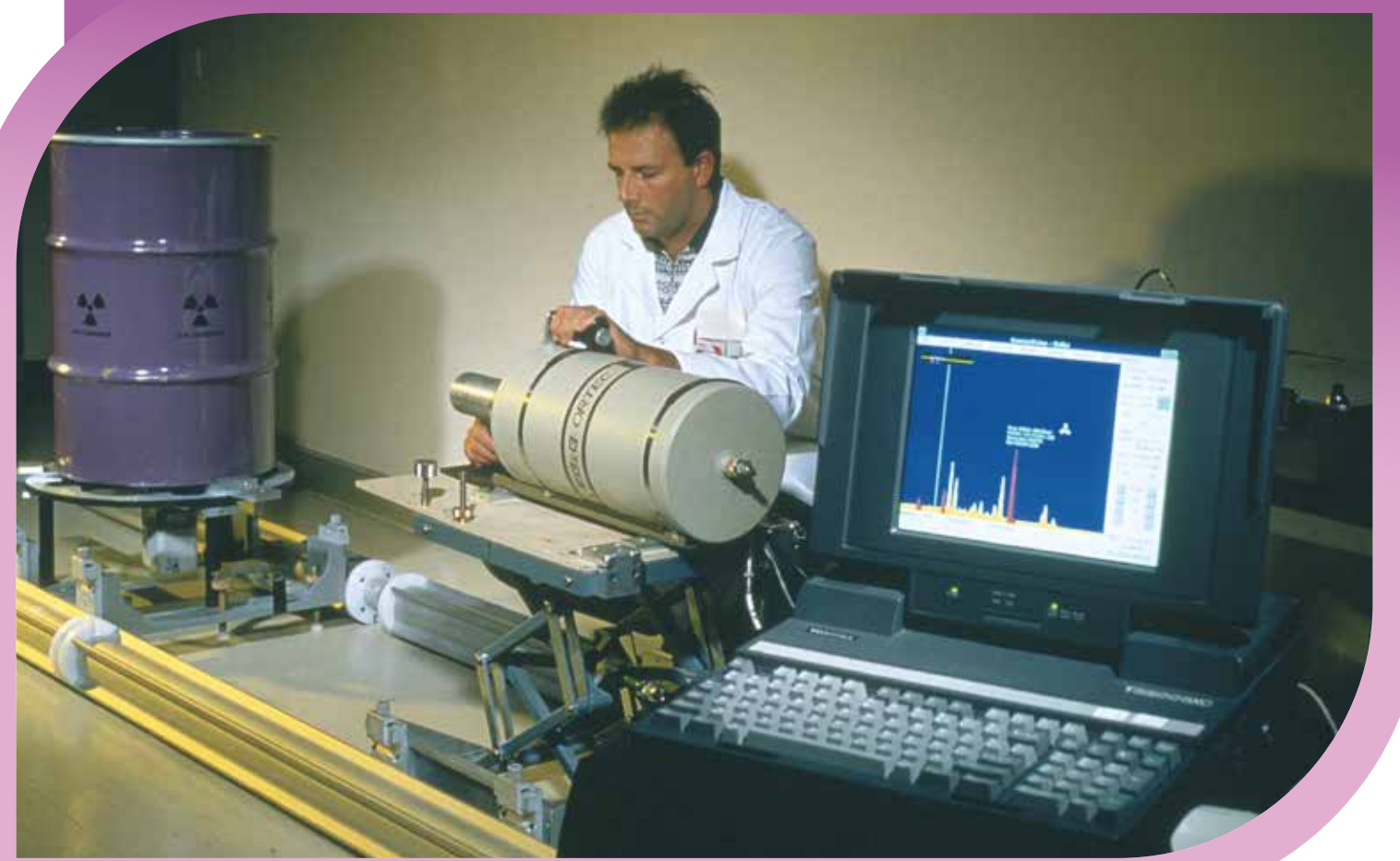
Spectrométrie alpha ( \alpha ) et gamma ( \gamma ) associée à un logiciel de modélisation
