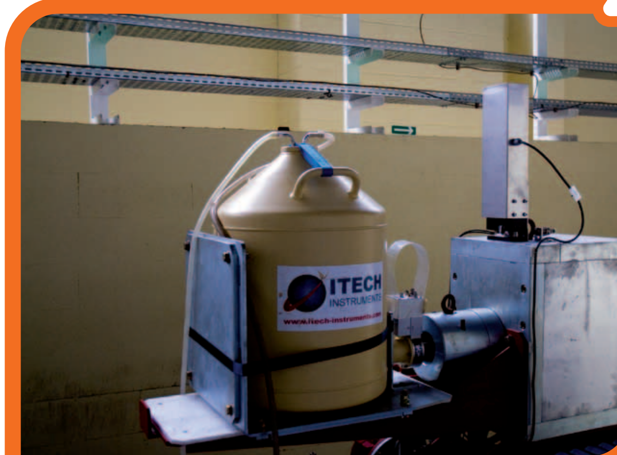
Spectrométrie gamma : détecteur GeHP (germanium hyperpur), pour déterminer l'activité gamma des radioéléments et vérifier la conformité avec les spécifications de l'Andra.
