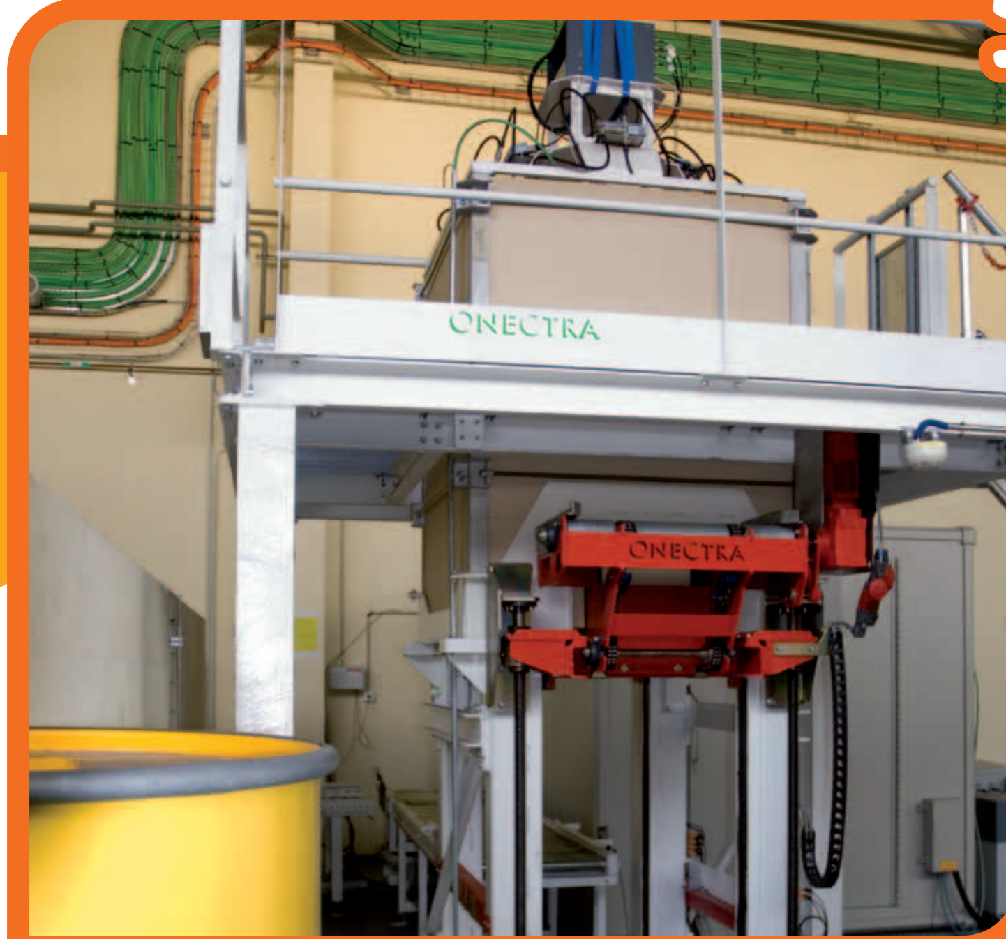
Comptage neutronique passif : 16 détecteurs à ^3\text{He} .
