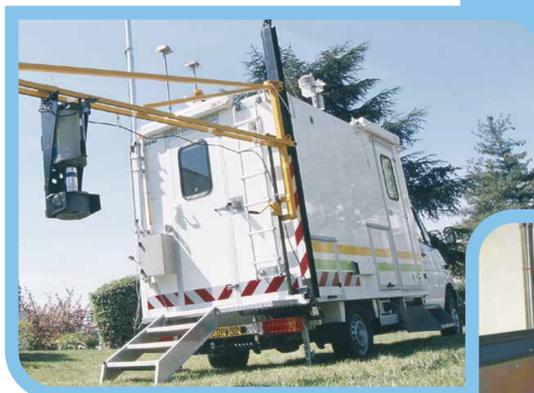
Laboratoire mobile permettant les analyses *in situ*.
