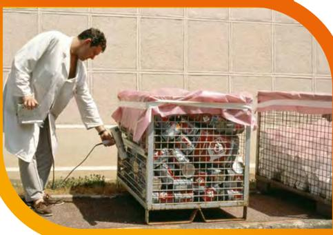
Contrôle des colis avant départ : mesure d'irradiation par le service de radioprotection du site.
