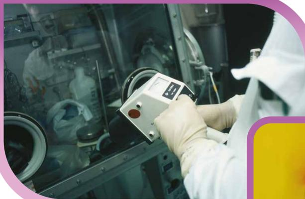
La babyline et le FieldSpec<sup>®</sup> sont utilisés pour quantifier les émissions bêta ( $\beta$ ) et gamma ( $\gamma$ ).
