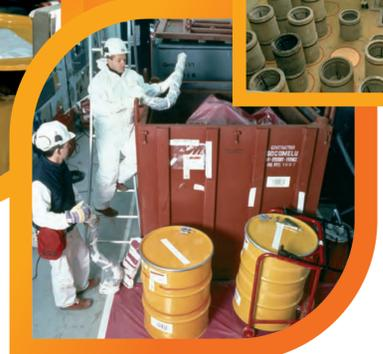
De gauche à droite : conditionnement en fûts, en caissons, en coques bétonnées.
