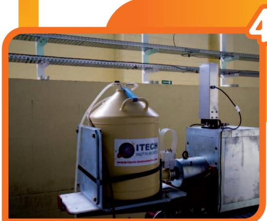
Spectrométrie gamma : détecteur GeHP (germanium hyperpur), pour déterminer l'activité gamma des radioéléments et vérifier la conformité avec les spécifications de l'Andra.
