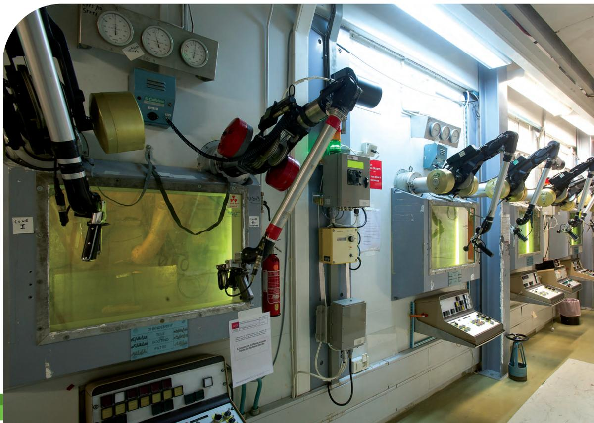
Une chaîne blindée est un dispositif de radioprotection qui permet de manipuler à distance des produits irradiants ou chimiques. Ici, la chaîne blindée Cyrano du bâtiment 18, vue de
