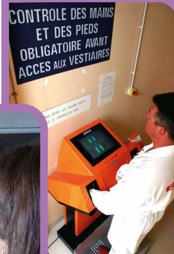
Les contrôles de non contamination corporelle et vestimentaire sont obligatoires en sortie de zone contrôlée : Sirius (contrôleur mains-pieds et vêtements).
