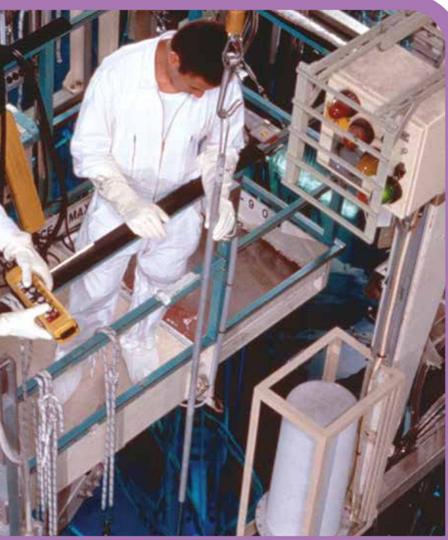
Le coffret de signalisation et d'alarme (en haut à droite), et la chambre d'ionisation (en bas à droite) mesurent l'irradiation ambiante dans le réacteur expérimental Osiris à Saclay.
