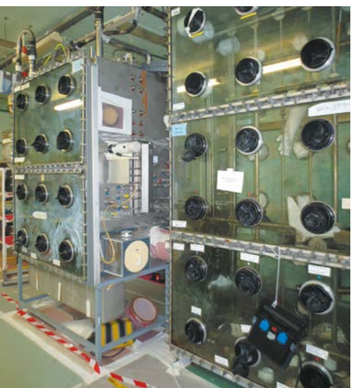
Assainissement de boîtes à gants dans l'installation Prodiges.
