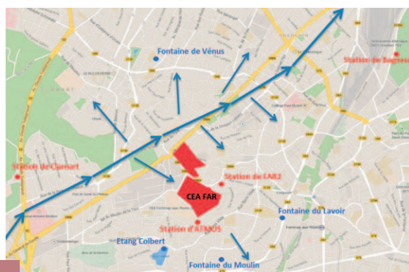
Implantation des stations de contrôle de l'environnement. Les flèches bleues indiquent la direction d'écoulement de la nappe phréatique.
