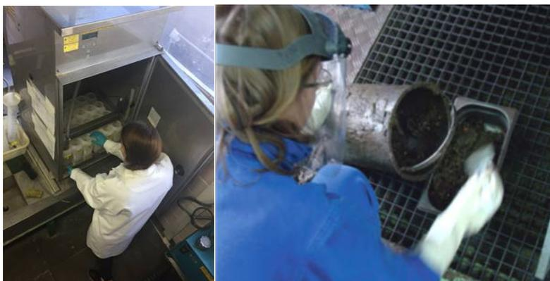
*Surveillance en continu des émetteurs  $\beta\gamma$  de l'égout urbain et prélèvement de boues.*
